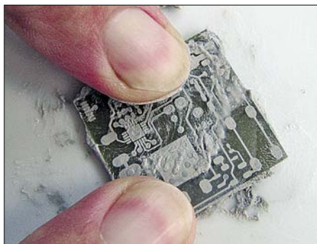
Bild 3: Reinigung von länger gelagerten, chemisch verzinnnten Platinen mit Seife und Wienerkalk
